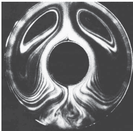
Рис. 2. Линии тока в конвективном движении между соосными цилиндрами
