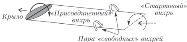
Рис. 2. Вихревая схема крыла в первом приближении
